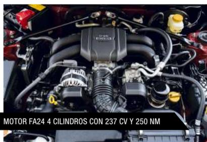
MOTOR FA24 4 CILINDROS CON 237 CV Y 250 NM
