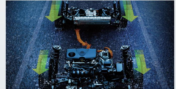
Se trata de un nuevo sistema de tracción electrónica inteligente denominado "e-Four" que proporciona torque en las 4 ruedas según la situación lo demande. Este sistema fue desarrollado para brindar una conducción propia de un SUV y una excelente eficiencia en combustible.
