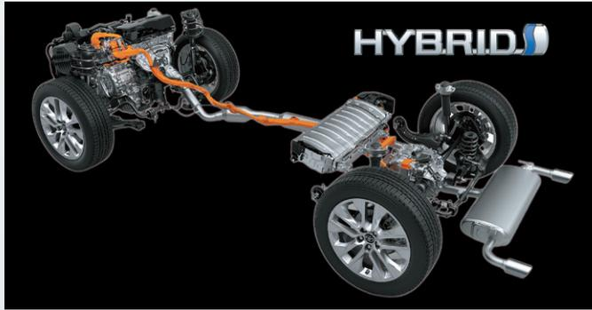
El nuevo sistema híbrido auto-recargable de Toyota RAV4 está compuesto por **dos motores** (naftero + eléctrico) que trabajan conjuntamente, otorgando una potencia total de **222 CV**.
