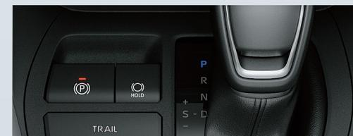
FRENO DE ESTACIONAMIENTO ELÉCTRICO CON FUNCIÓN "AUTO-HOLD".
