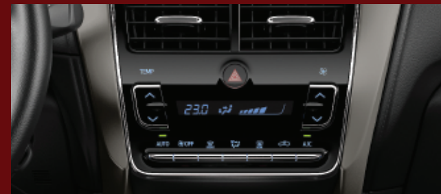
Aire acondicionado con climatizador automático digital. (1)
