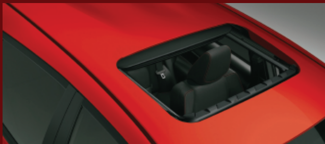
Techo solar eléctrico. (2)
