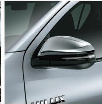
**Espejos retrovisores:** funcionalidad y diseño se unen. Los espejos retrovisores cromados suman regulación y rebatimiento eléctrico, guiño incorporado y desempañador.
