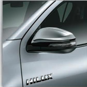
Espejos eléctricamente retráctiles, con desempañador y regulación eléctrica.<sup>2</sup>
