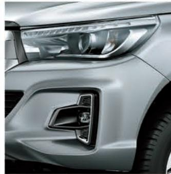
**Faros:** en la parte superior se destacan los faros de LED con proyector y luces diurnas (DRL) de LED y en la parte inferior los faros antiniebla de LED.
