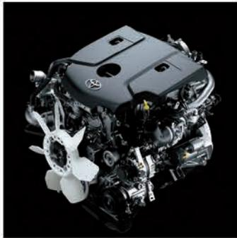
**Nuevos motores Toyota:** dos alternativas diesel con turbo de geometría variable, 1GD (2.8l) y 2GD (2.4l). Ambos mejoran notablemente la aceleración en bajas y medias velocidades así como también el consumo de combustible.
