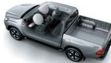
**7 Airbags<sup>1</sup>:** frontales y laterales para el conductor y el acompañante, airbag de rodilla para el conductor y airbags de cortina en ambos lados, sumando en total 7 airbags para mejorar la seguridad de los pasajeros.
