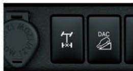
**Bloqueo de diferencial trasero<sup>2</sup>:** para maximizar la capacidad off-road, el bloqueo de diferencial trasero permite distribuir en partes iguales el torque para que las ruedas posteriores giren a la misma velocidad sin tener en cuenta las diferencias de tracción.
