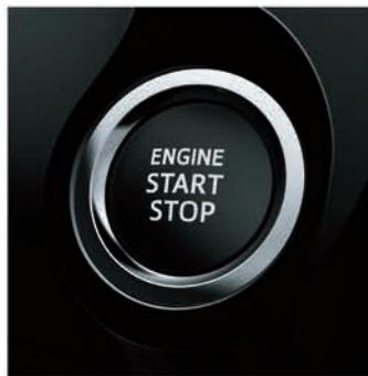
**Sistema de encendido por botón (Push Start Button)<sup>1</sup>:** el sistema permite encender o apagar el vehículo simplemente presionando un botón.
