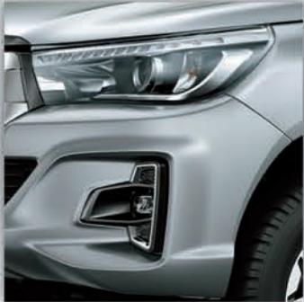
Faros delanteros de LED con proyector, regulación automática en altura y luces diurnas (DRL) de LED.<sup>1</sup>
