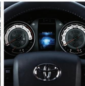
**Tablero de instrumentos<sup>3</sup>:** el nuevo diseño del display de información múltiple color de 4.2" (TFT) brinda la información esencial para asistir al conductor mientras conduce.
