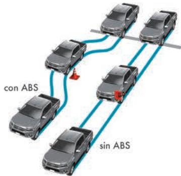
**ABS con EBD y BA:** el ABS con Distribución Electrónica de la Fuerza de Frenado (EBD), permite frenar manteniendo el control, independientemente de la cantidad de carga que lleve. El Asistente de Frenado de Emergencia (BA) aplica presión adicional al sistema de frenos cuando detecta una frenada de emergencia.
