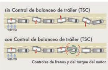
**El control de balanceo de tráiler (TSC):** ayuda a mantener la pickup y su remolque en línea recta compensando el balanceo con los frenos y respuesta del motor.
