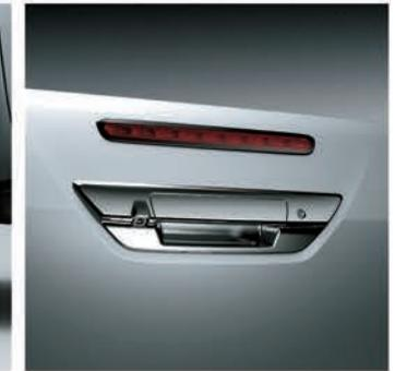
**Cámara de retroceso integrada:** el diseño de la apertura de la caja incorpora de manera estética la cámara de retroceso, dejándola en una posición óptima para la asistencia de manejo.
