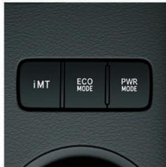
**iMT<sup>1</sup>, ECO y Power Mode<sup>2</sup>:** permiten optar por la mejor alternativa de conducción; fluidez en el cambio de marchas con el iMT (Transmisión Manual Inteligente), mejora en el consumo de combustible (ECO) o agilidad en la aceleración (POWER).
