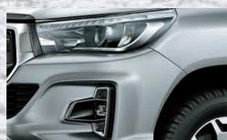
Faros delanteros de LED con proyector y regulación automática en altura. Luces diurnas (DRL) de LED.
