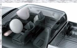
Airbags frontales (conductor y acompañante), laterales (x2) y de cortina (x2).
